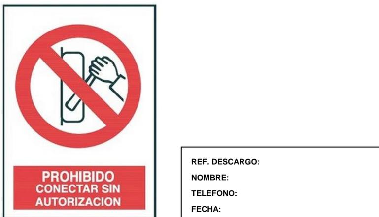
Podrán ser adhesivas o sólidas, y se colocarán en el elemento de bloqueo, o en su defecto en el accionamiento, en la maneta de mando, o bien en la inserción de la manivela o palanca de accionamiento.
